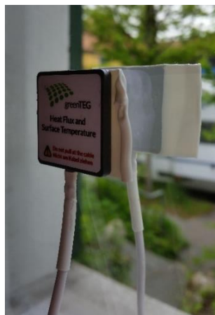
Fig. 2: Fensterscheibe mit Sensoren auf beiden Oberflächen.
