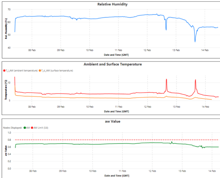
Abbildung 4-3: Messdaten von Kellerraum 1
