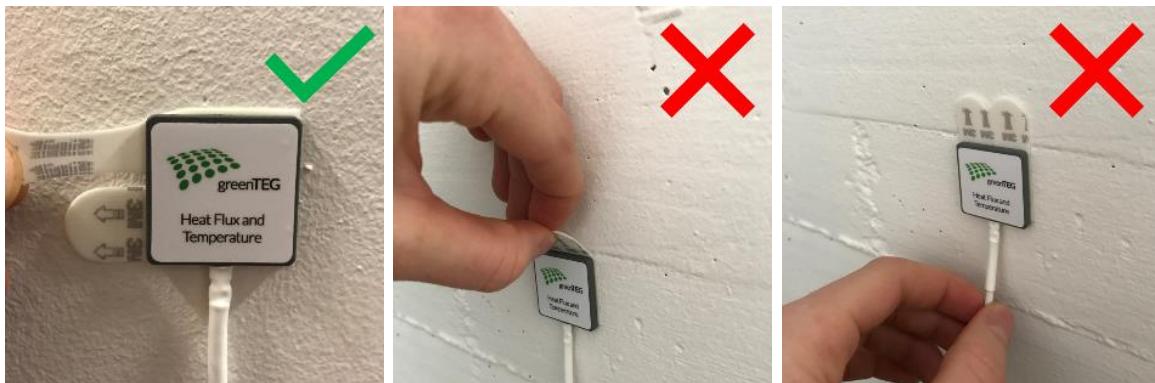
Bild 6: Korrekte (links) und falsche Vorgehensweise (mitte, rechts) beim Entfernen eines Oberflächen-Sensors.
