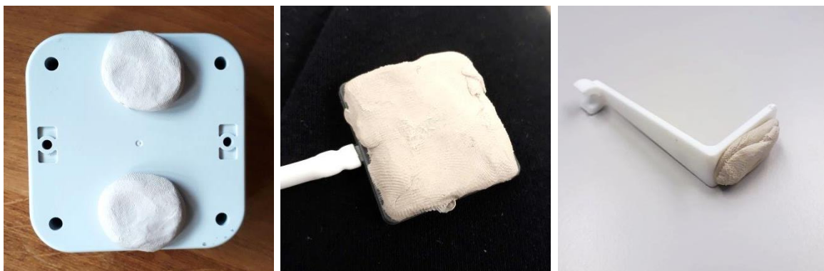
Bild 1: Korrekte Anbringung der Knetmasse für die Montage Links: Auf der Rückseite der Node; Mitte: Auf der Sensorrückseite; Rechts: An der Montagefläche des Sensorhalter.
